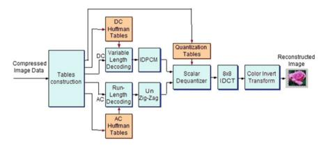
Fig. 10 JPEG decompression structure
